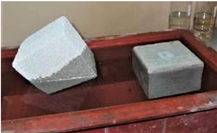
Фото 6. Блоки из пенобетона и ячеистого бетона в воде.
