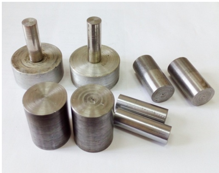
Рис. 6. Стержни различных диаметров для испытания пластинок.
