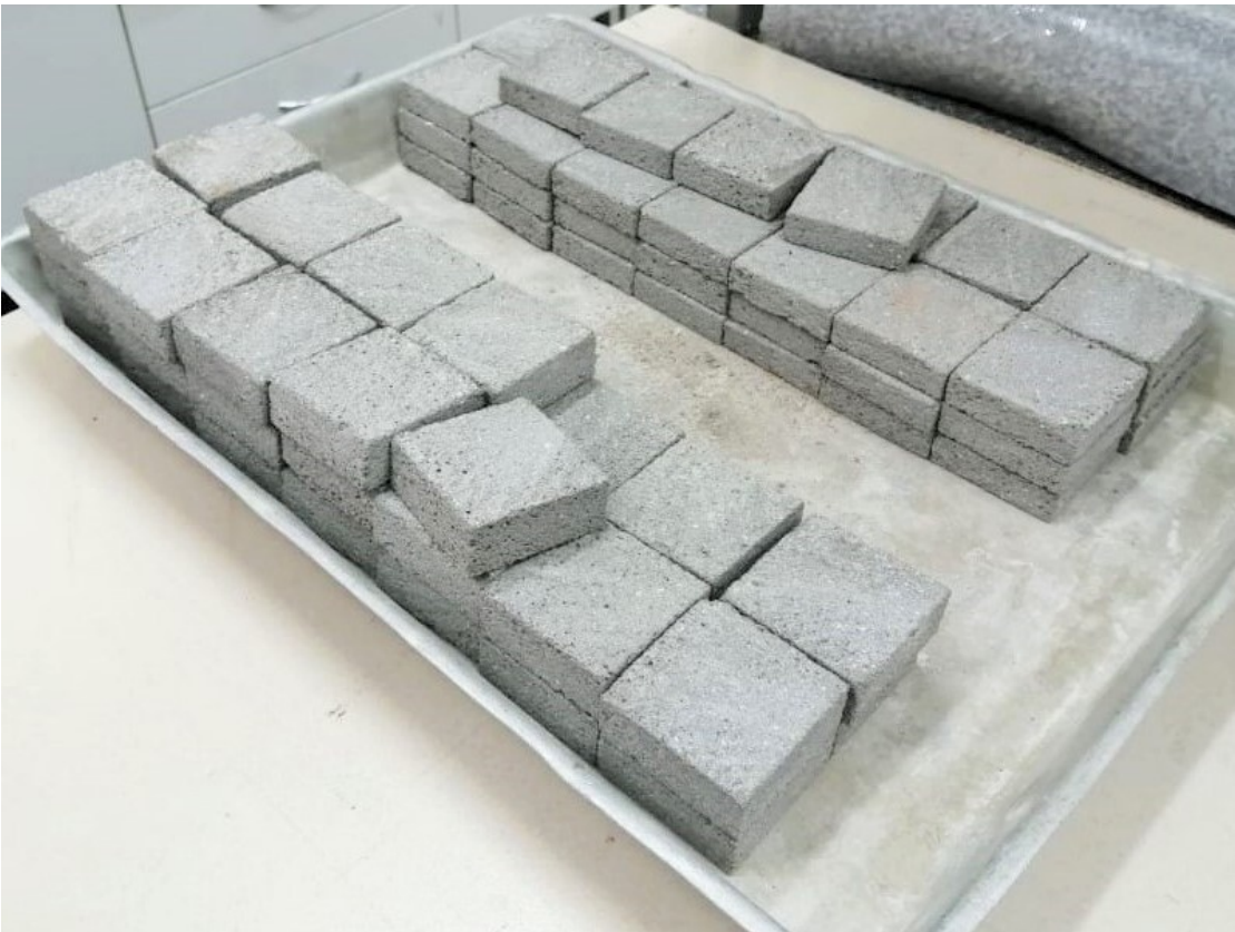
Рис. 3. Изготовленные для испытания образцы-пластины.
