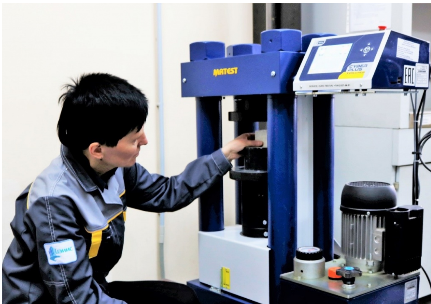
Рис. 4. Испытание контрольных образцов-кубов на прессе MATEST E 160N.
