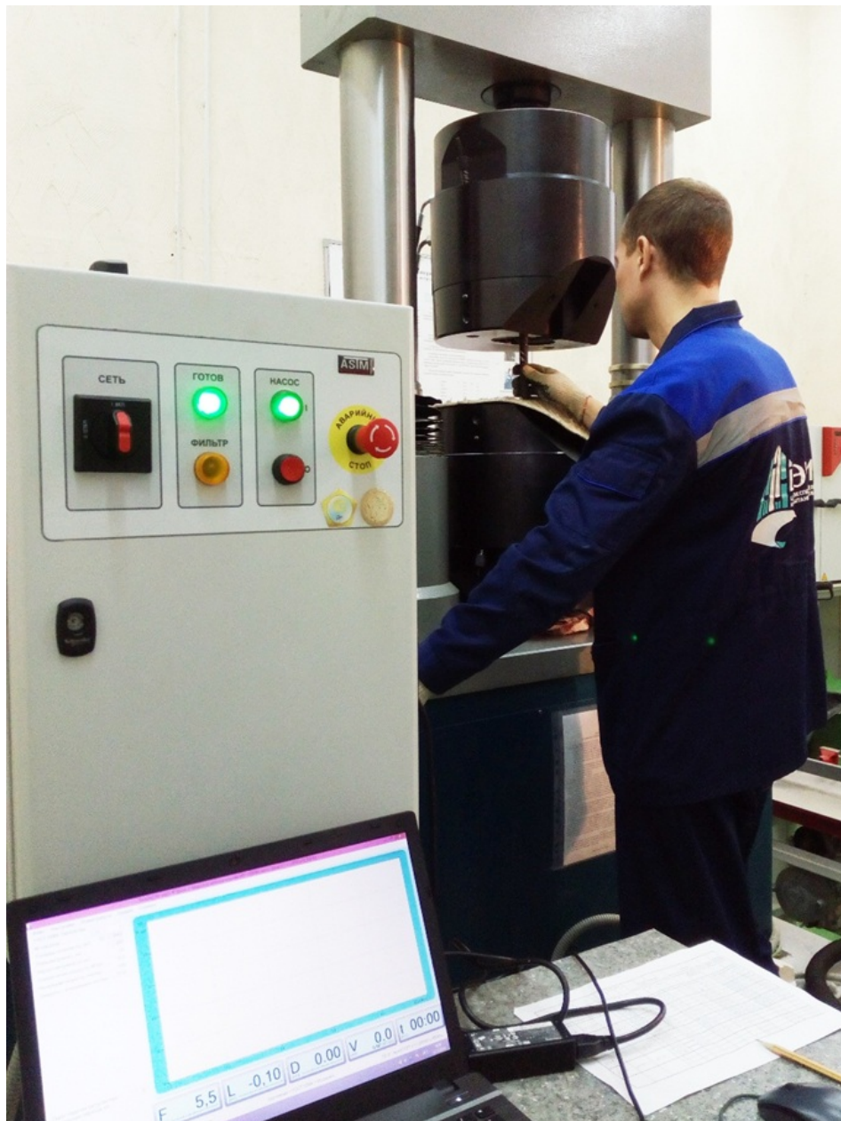
Рис.1. Испытания арматурной стали на растяжение.
