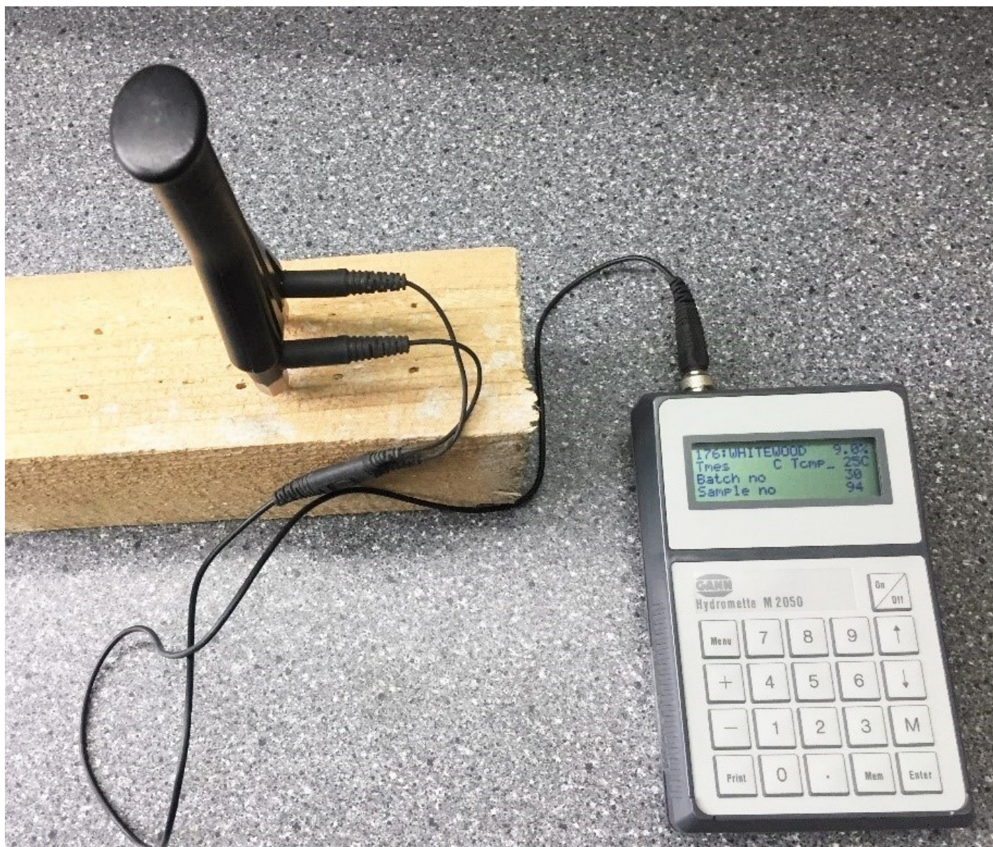
Фото 2. Влагомер-микропроцессор древесины HYDROMETTE-M-2050
