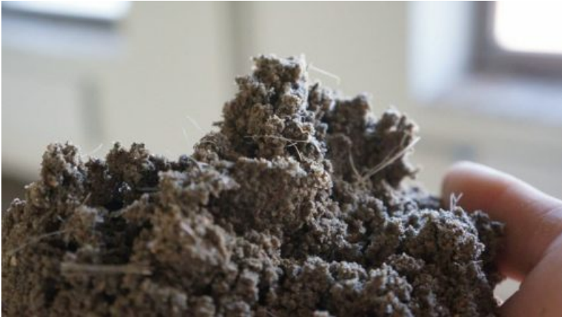
Фото 1. Фиброволокно в полусухой стяжке.
