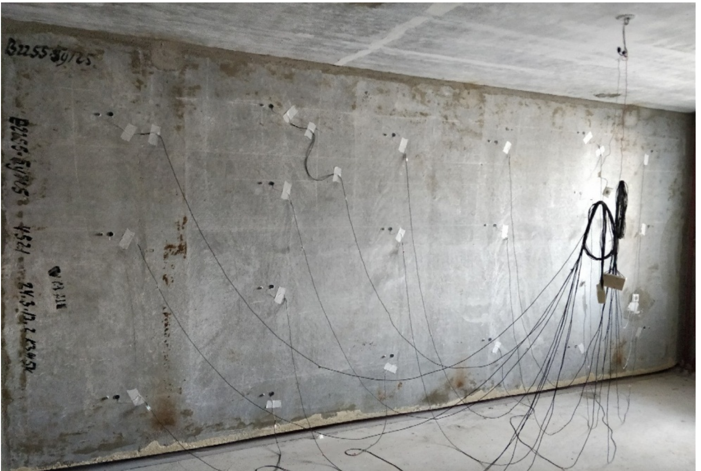
Фотография 1. Трёхслойная панель с 20 датчиками теплового потока.
