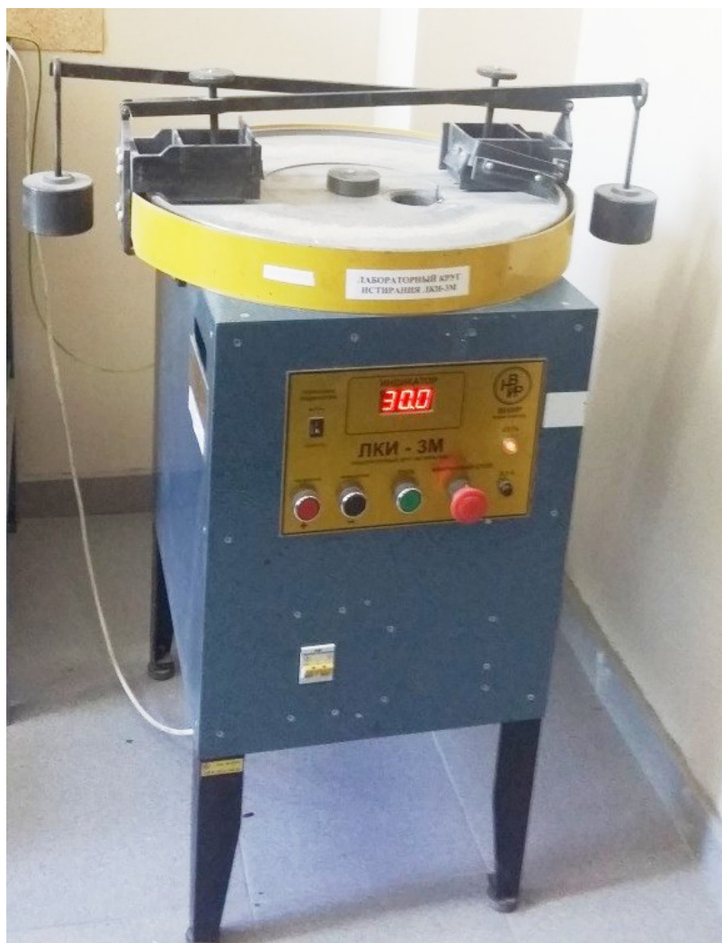
Рис.1. Лабораторный круг истирания типа ЛКИ-ЗМ.
