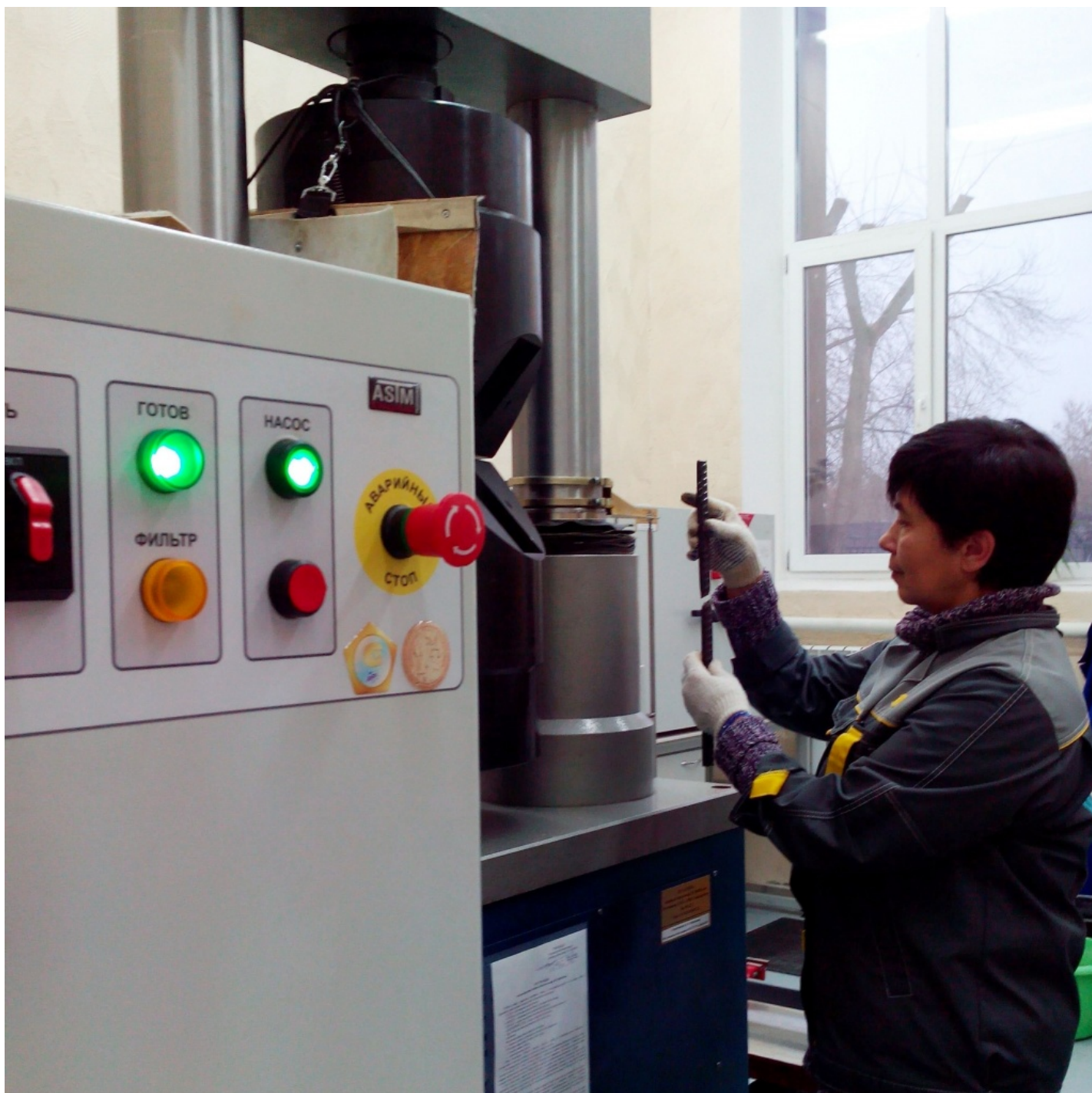
Рис.2 - Испытания арматурной стали на растяжение.
