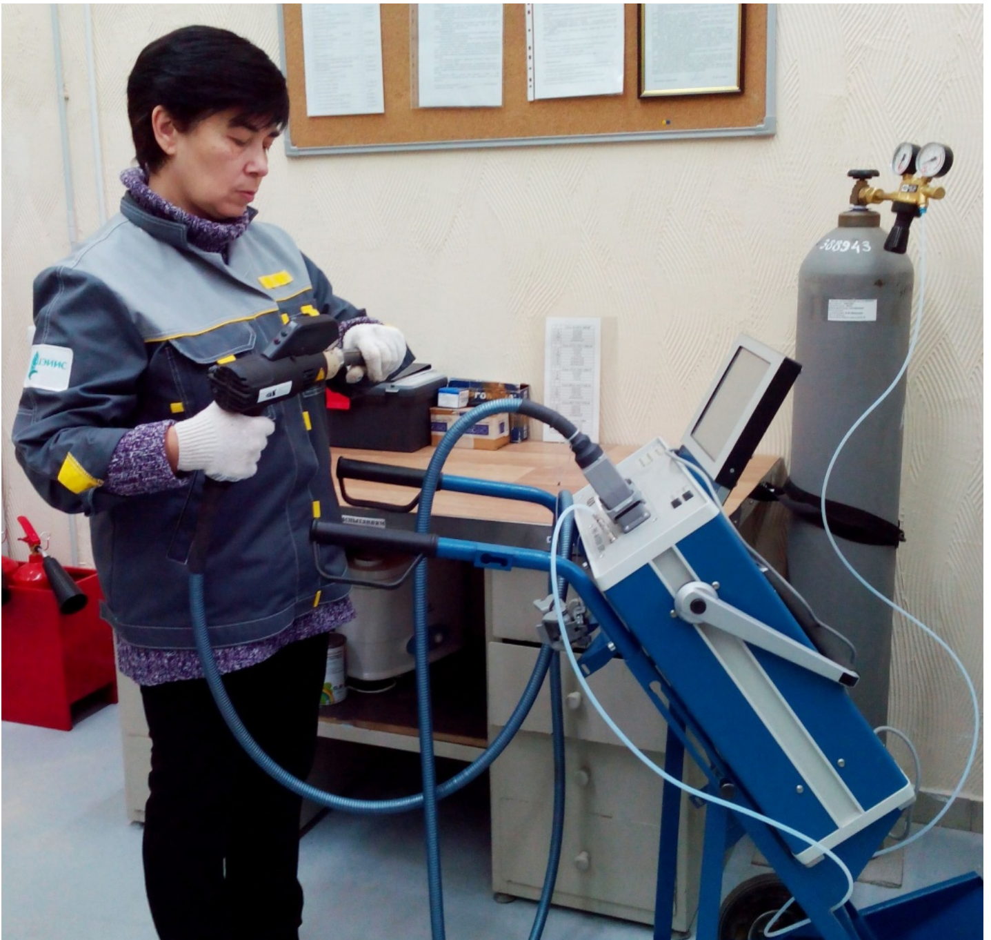
Рис.1 - Испытание арматурного стержня для определения химического состава стали.
