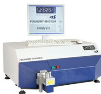
Рис.5. Спектрометр FOUNDRY-MASTER Xline UVR.
