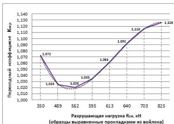
Рис.5. Переходные коэффициенты для определения разрушающей нагрузки по базовому методу испытания.
