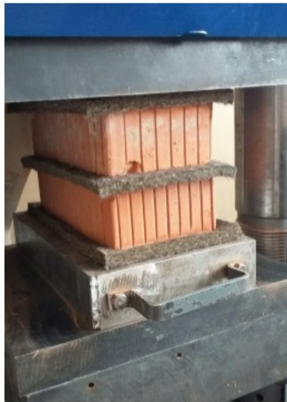
Рис.2. Испытание образцов выравненных прокладками из технического войлока.
