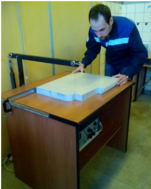
Рис.2. Стенд для подготовки образцов из пенополистирольных плит.
