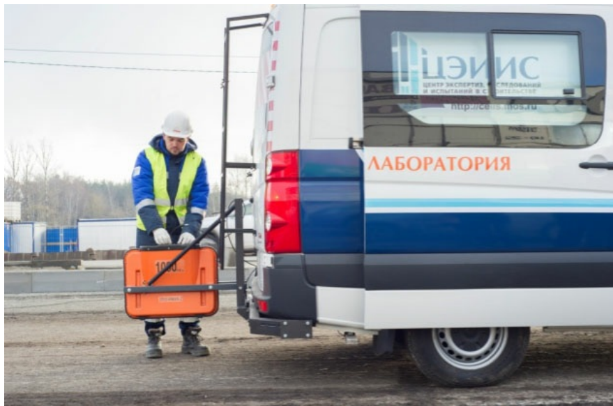
Рис.1. Георадар «Око-2», закрепленный при помощи специальной подвески на автомобиле.
